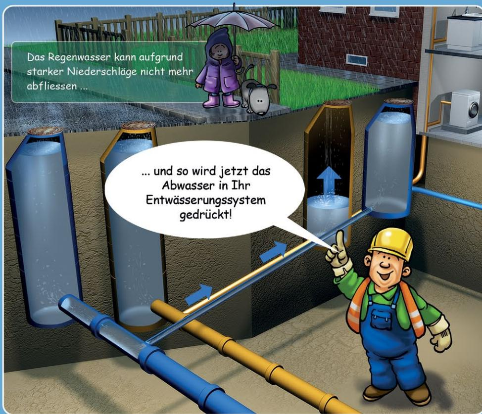
Bei Abwasserleitungen wird von Rückstau gesprochen, wenn Abwasser vom öffentlichen Kanal unter anderem in die Entwässerungsleitungen des Privatgrundstücks gedrückt wird.
