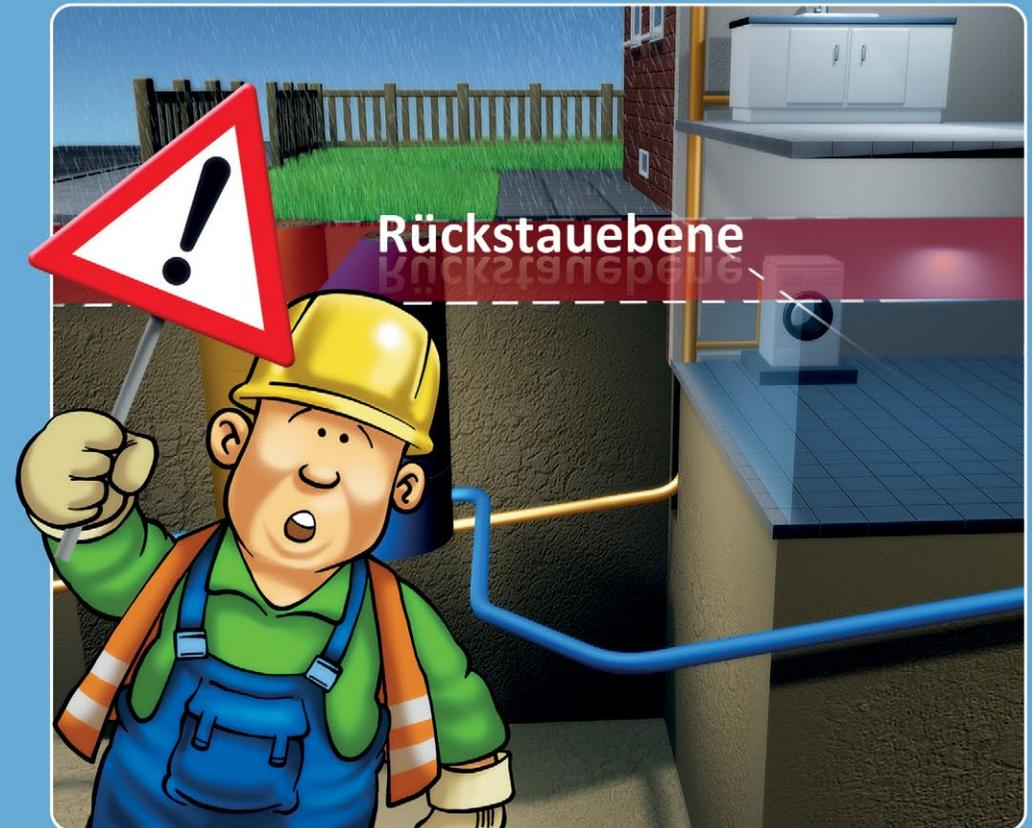
Die Rückstauenebene markiert den höchstmöglichen Stand des Abwassers an einer bestimmten Stelle in einem Kanalsystem. Sie ist definiert als die höchste Ebene, bis zu der das Wasser in einer Entwässerungsanlage ansteigen kann.
