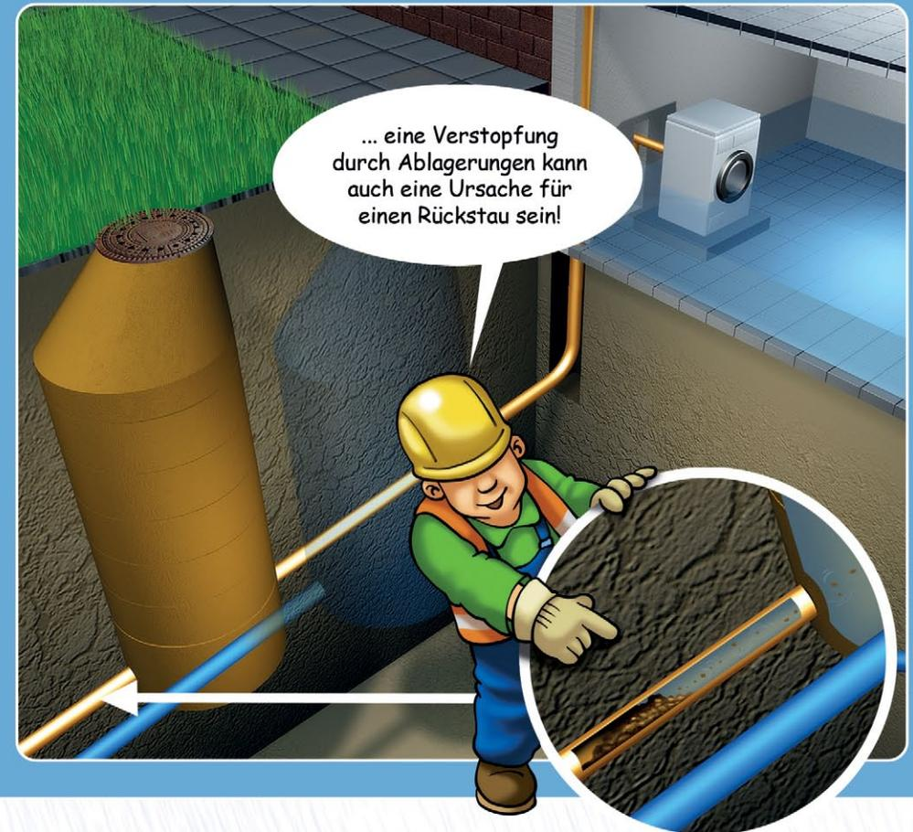
Rückstau im Kanal entsteht in den meisten Fällen bei außergewöhnlichen Starkregenereignissen. Hierbei reicht die Kapazität des vorhandenen Kanalnetzes nicht aus, um für eine sofortige Ableitung des anfallenden Niederschlagswasser zu sorgen. Bei dieser kurzfristigen Überlastung des Kanal-
