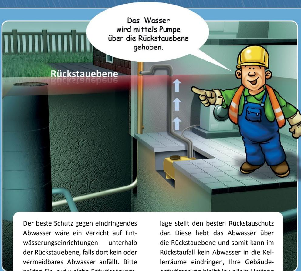
Der beste Schutz gegen eindringendes Abwasser wäre ein Verzicht auf Entwässerungseinrichtungen unterhalb der Rückstau ebene, falls dort kein oder vermeidbares Abwasser anfällt. Bitte prüfen Sie, auf welche Entwässerungsgegenstände Sie verzichten können! Haben Sie unverzichtbare Entwässerungseinrichtungen unterhalb der Rückstau ebene, so beachten Sie bitte die folgenden Punkte:
